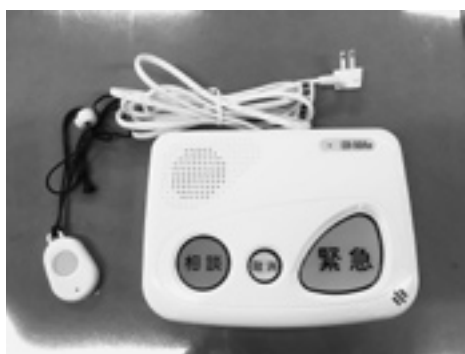
▲緊急通報装置
